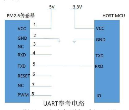
注: UART接口电平3.3V, MCU端如是5V, 建议加电平转换, 或串200R电阻 MCUTXD此网络可不接。
